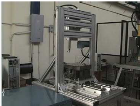
Gráfico 11: CMM Plataforma Experimental Digitalizadora y Medición por Coordenadas
