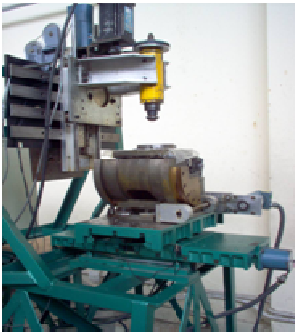
Gráfico 11: CMM Plataforma Experimental Digitalizadora y Medición por Coordenadas
